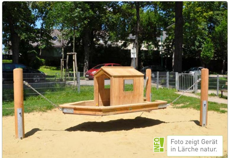
**Beschreibung:** Rahmenkonstruktion aus Kantholz 9/11 cm, Boden aus Siebdruckplatte 20 mm, Hausaufbau aus Kantholz 7/7 cm, mit aufgeschraubten 3-Schichtplatten 20 mm. Aufhängung mittels 3 Ketten mit 3 Kreuzgelenken, an 3 Stehern (Pfosten), BSH Ø 16 cm.
