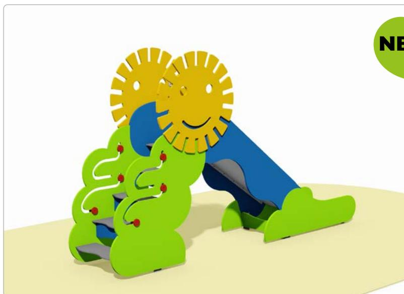
Beschreibung: 2 Seitenteile aus je 4 Elementen, aus HDPE-Platte 19 mm in unterschiedlichen Farben, an den Stößen überblattet und verschraubt, je 1 Stk. Platte mit Schiebe-Elementen, je 1 Stk. Platte mit lustigem Sonnen-Design, 1 Rutschblech, Edelstahl, 2 mm stark, gekantet, 1 Handlauf, Edelstahl, 1 Einzelpodest ca. 55 x 42 cm und 4 Trittstufen aus HPL-Platte 10 mm, rutschhemmend, 4 Setzstufen aus HDPE-Platte 19 mm.
