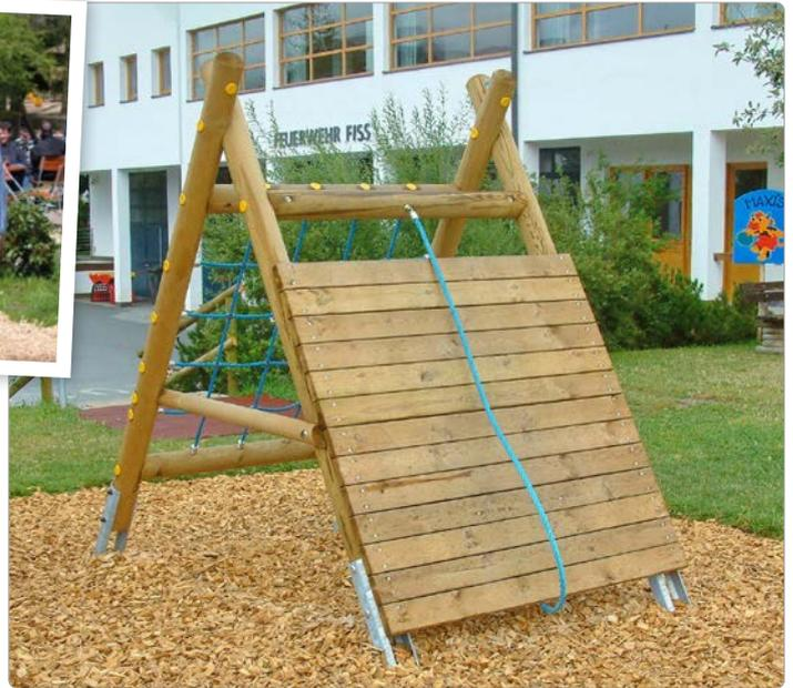
Beschreibung: 1 Netzteil aus 2 Längs- und 2 Querholmen, 1 Herkules-Kletternetz, 1 Schiefe Ebene aus 2 Längs- und 1 Querholm(en), Belag aus Kanthölzern 4/11 cm, 1 Herkules-Hangeltau, an beiden Enden befestigt, 2 Durchlaufsicherungen Ø 8 cm, alle Knotenpunkte besitzen form- und kraftschlüssige Holzverbindungen.
