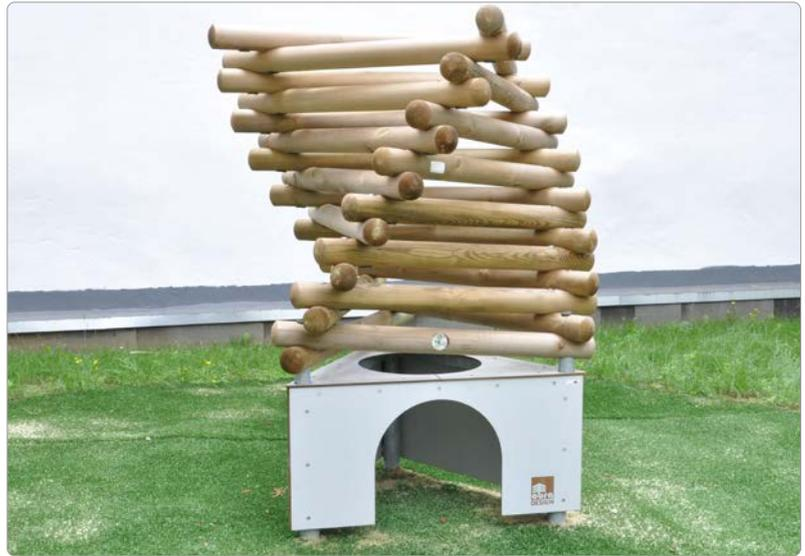
Beschreibung: Kletterskulptur aus 25 Rundhölzern Ø 10 cm, mit Sockel aus verschweißter Stahl-Unterkonstruktion aus Formrohren 60/60/4 mm und Rohren Ø 76 mm, mit 4 Stk. HPL-Platten, grau, beplankt.
