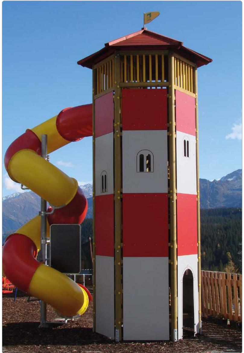
Beschreibung: Sechseckturm mit 6 Außen- und 1 Mittelsteher, Rundhölzer Ø 12 cm, 10 Dreieckpodeste führen stufenförmig bis in eine Höhe von 4,50 m, zum Röhrenrutscheneinsatz. Für die Turmverkleidung werden HPL-Platten verwendet, 7 Zwischenleitern, 6 Absturzsicherungen, 1 Zeltdach.
