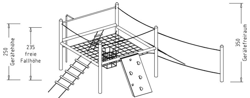
Beschreibung: 5 Steher (Pfosten), Rundhölzer Ø 14 cm, 4 Querhölzer Ø 12 cm, 1 Quadrat-Kletternetz mit Netztrichter, 1 Feuerwehr-Kletterstange, 1 Strickleiter, 1 Netzeinstieg ohne Rahmen, 1 Bergsteiger-Kletterwand, 1 Balken-Kettenaufstieg, 1 Balanciertau mit Haltetau, 3 Handlaufseile, 1 Handlauf in Niro.
