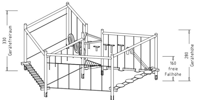
Beschreibung: 3 Steher (Pfosten) Ø 12 cm, 5 Steher Ø 14 cm, 1 Dreieckspodest, 3 Handläufe, 6 Aussteifungshölzer, 9 Balancierstrecken: 3 Paar Fußstapfen, 1 Balancierbalken, 1 Wackelhölzerwand, 1 Reifenwand, 1 Seilwand, 1 Balanciertau mit horizontalem Haltetau, 1 Balanciertau mit vertikalen Halteseilen, 1 Wackelteller, 1 horizontale Strickleiter.
