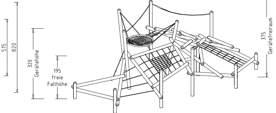
Beschreibung: Kletterkonstruktion aus 12 Stehern (Pfosten) und 22 Balancierhölzern aus Rundhölzern Ø 14 cm, 1 Herkules-Flächennetz, 1 Herkules Aufstiegsnetz, beide aus Ø 16 mm Herkulestau, 6 Herkules-Halteseile Ø 22 mm, 1 Nestkorb mit Gurtgeflecht an Ketten abgehängt, 1 Strickleiter, 1 Klettertau.
