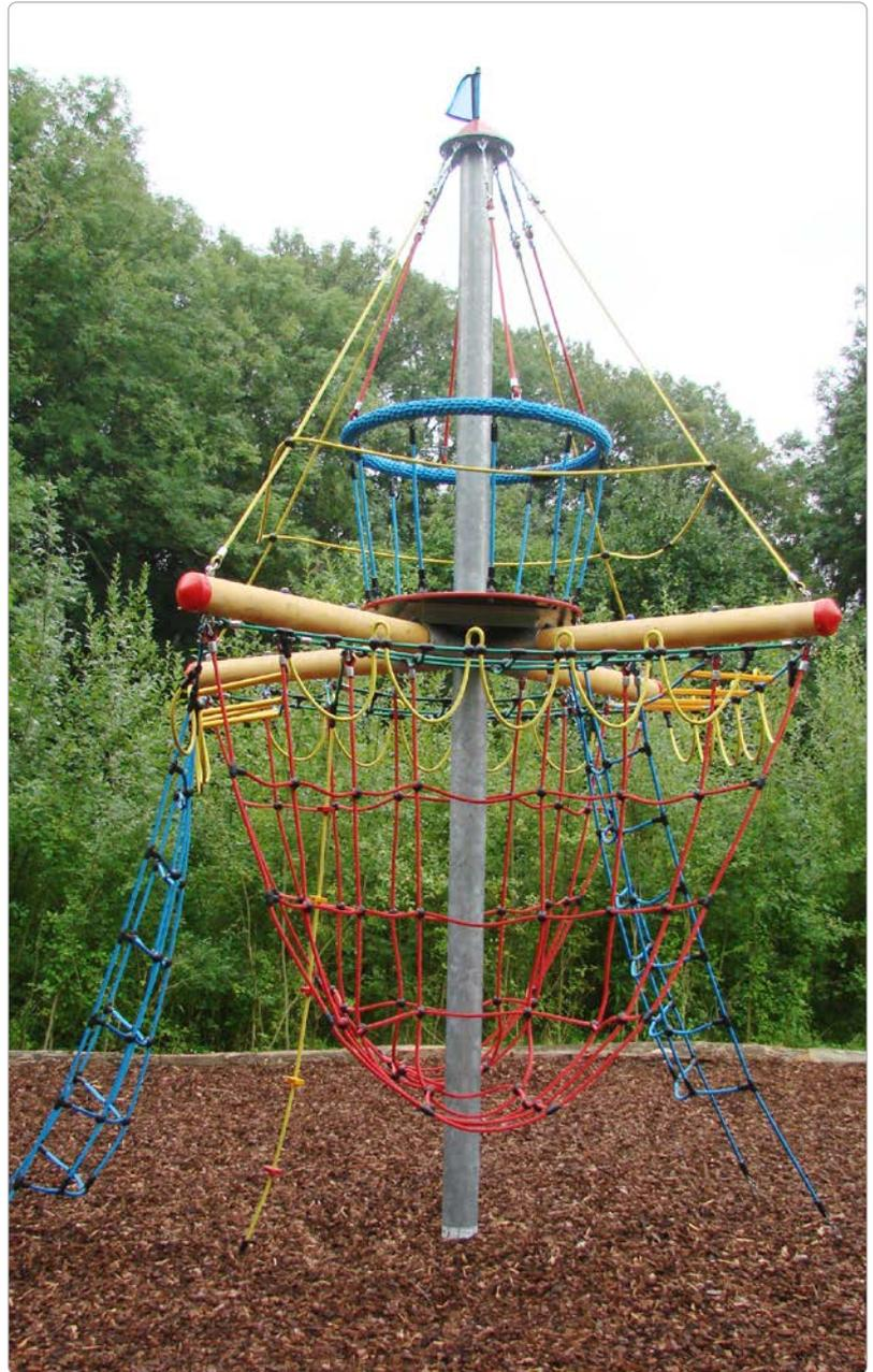
**Beschreibung:** 1 Stahlmast, feuerverzinkt, mit kreuzweise angeschweißten Rohrstützen, zur Aufnahme von 4 runden Querhölzern, aus lasiertem Leimholz, wasserfest verleimt, 1 Klettertau, mit Kletterhilfen, 2 schräge Aufstiegsnetze, 2 Relax-Netze, 2 Horizontalleitern, 2 Horizontalnetze, 4 Girlandenseile, 1 Aussichtsplattform, mit kreisrundem Stahlrohr-Handlauf, seilumwickelt, diverse Halteseile.
