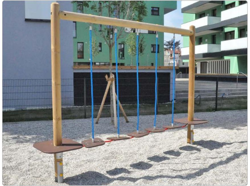
Beschreibung: 2 Steher (Pfosten) Ø 12 cm, 1 Längsbalken Ø 12 cm, kerngetrennt (kernfrei), 1 Wackelweg aus Herkulesseil Ø 16 mm, mit Gewindestiften Ø 12 mm verpresst, mit 5 Wackelteller aus Siebdruckplatte, durchgeschraubt, vertikale Seile am Längsbalken beweglich befestigt, horizontales Seil Ø 22 mm mit M16 beweglich verschraubt, 2 Plattformen aus Siebdruckplatten, mit Stahlwinkel, feuerverzinkt, abgestützt.
