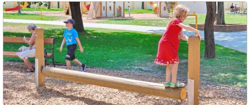
Beschreibung: 1 Rundholz Ø 20 cm, mit Kern, 2 Rundholzsteher, BSH Ø 16 cm. Die Balancierrolle ist an den Stirnenden mit Stahlplatten verschraubt, Lagerachsen sind ausmittig angeordnet, damit das Balancieren nicht zu schwierig ist, Kugellagerung.
