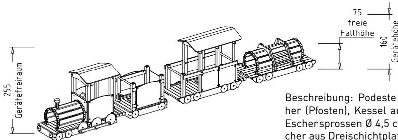
Beschreibung: Podeste aus KH 9/17 cm, Belag KH 3,5 x 10 cm genutet, 16 Steher (Pfosten), Kessel aus Stahlbögen mit Kanthölzern verkleidet, 3 Handläufe aus Eschensprossen Ø 4,5 cm, 1 Spielelement mit Lenkrad, 6 Brüstungselemente, 2 Dächer aus Dreischichtplatten. Der Zug wird in Bauteilen vormontiert geliefert.
