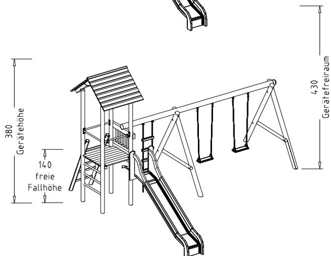
Beschreibung: 1 Turmteil mit Brüstungselement, 1 Turmteil mit Sprossenwand senkrecht, 1 Podest, 2 A-Stützen, 1 Schaukelbalken 4,9 m, 2 Sicherheitsschaukeln standard, 4 Abhängungen, 1 Strickleiter aus Stahlseil, 1 Leiter. Best.Nr. 43061 zusätzlich mit 1 Dach.
