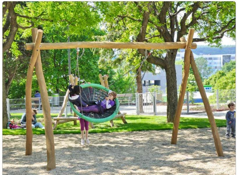
Beschreibung: 2 A-Stützen, Mindest  $\varnothing$  14 cm, 1 Schaukelbalken, Mindest  $\varnothing$  16 cm, 1 Schaukelkorb mit Seilumwicklung, Original Vogelnest, an 4 Ketten, 2 Abhängungen kugelgelagert, mit M16 durchgeschraubt, 2 Sicherheitsketten, Schrauben Edelstahl. Die Schaukel ist als Bausatz vorproduziert, die Bohrungen für die Schaukellager müssen im Zuge der Montage hergestellt werden.
