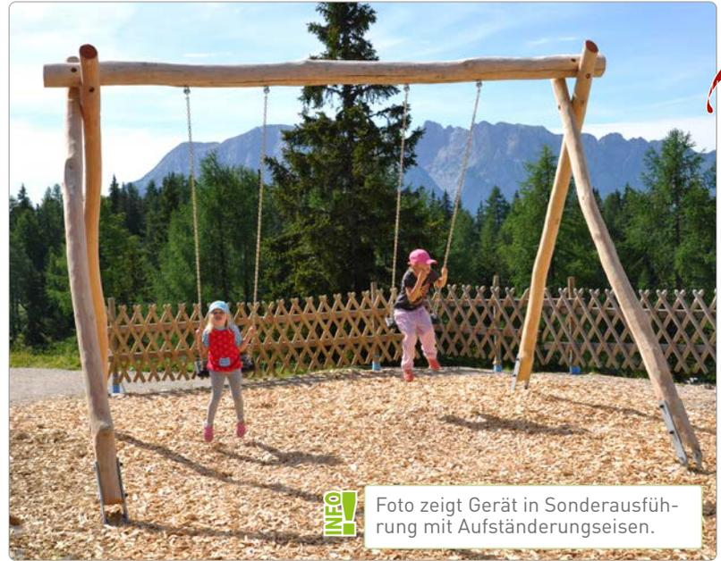
Beschreibung: 2 A-Stützen, Mindest  $\varnothing$  12 cm, 1 Schaukelbalken, Mindest  $\varnothing$  16 cm, 2 Sicherheitsschaukeln standard an 6 mm Ketten in Edelstahl, 4 Abhängungen, kugelgelagert, mit M16 durchgeschraubt, Schrauben Edelstahl. Die Schaukel ist als Bausatz vorproduziert, die Bohrungen für die Schaukellager müssen im Zuge der Montage hergestellt werden.
