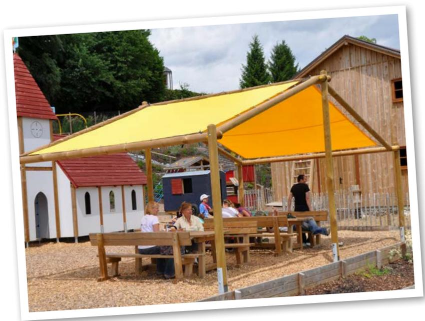
Beschreibung: 4 Steher (Pfosten), aus Rundhölzern Ø 12 cm, 1 Rahmen aus Rundhölzern Ø 12 cm, alle Verbindungspunkte form- und kraftschlüssig ausgeführt, Sonnensegel aus Texout Tentmesh 8020 Gewebe (ca. 340 g/m<sup>2</sup>) gefertigt, B1 brandhemmende Zusatzausstattung, Standardfarbe Gelb, mit Einhängehaken oder -ösen, werden mit Spannsenlen in den Rahmen wind- und wettersicher montiert.
