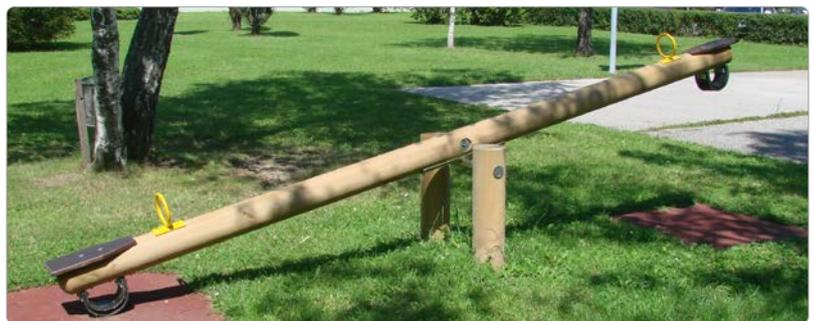
Beschreibung: 1 Wippbalken aus Brettschichtholz Ø 14 cm, 2 Wippgriffe aus Flach- und Rundstahl, verzinkt und gelb pulverbeschichtet, 2 Wippsitze Siebdruckplatte, Wippbalkendämpfung an beiden Enden mit Gummischlaufen mit Gewebeeinlage, Wippenlagerung mit Achse im Rohr, Polyamid-Gleitlager.
