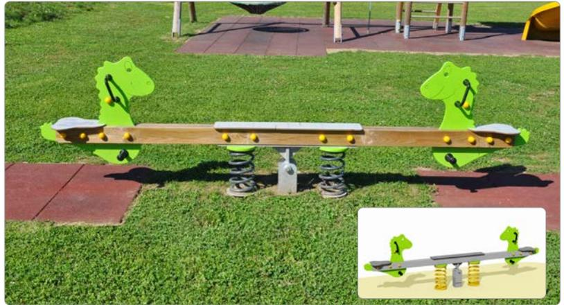
Beschreibung: 1 Wippbalken aus 2 Stk. Kanthölzern 4/11 cm (Best.Nr. 77010) bzw. Formrohr ca. 100/100/4 mm feuerverzinkt (Best.Nr. 77011), 2 konturfräste HDPE-Platten 19 mm, 2 Sitze und Standelement mittig aus HPL-Platte 10 mm, grau, mit strukturierter, rutschhemmender Oberfläche, 4 Haltegriffe und 4 Fußrasten aus Polyamid, 2 Federn Ø 17 cm und je 2 Federteller anthrazit pulverbeschichtet, 1 Wippensteher aus Formrohr 120/120
