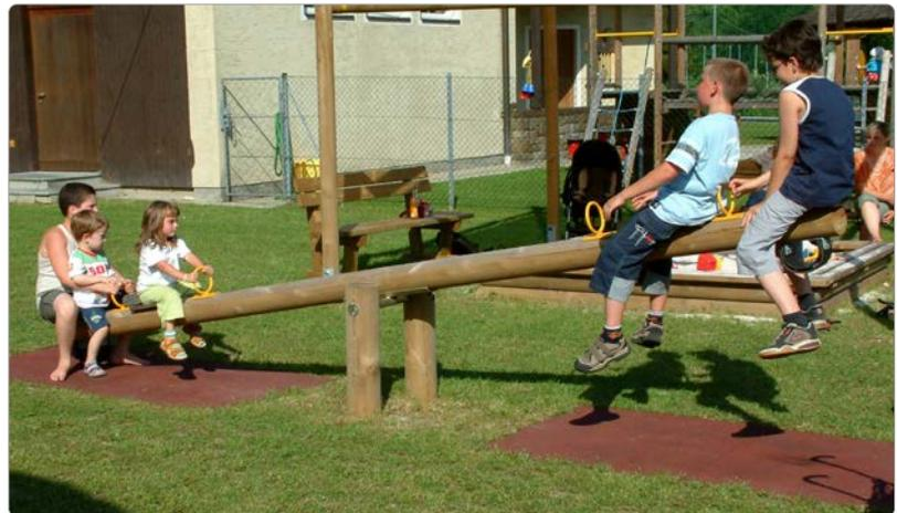
**Beschreibung:** 1 Wippbalken aus Brettschichtholz Ø 14 cm, 4 Wippengriffe aus Flach- und Rundstahl, verzinkt und gelb pulverbeschichtet, 4 Wippensitze aus Siebdruckplatte, Wippbalkendämpfung an beiden Enden mit Gummischlaufen, mit Gewebeeinlage, 2 Wippensteher aus Rundholz Ø 16 cm, Ausbildung als Tiefenanker, im Boden mehrfach mit druckimprägnierten Kanthölzern verbunden und verschraubt, daher verwindungssteif, Wippenlagerung mit Achse im Rohr, Polyamid-Gleitlager.
