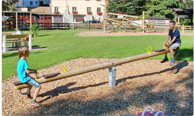
**Beschreibung:** 1 Wippbalken aus Brettschichtholz Ø 14 cm, 4 Wippengriffe aus Flach- und Rundstahl, verzinkt und gelb pulverbeschichtet, 4 Wippensitze aus Siebdruckplatte. Wippbalkendämpfung an beiden Enden mit Gummischlaufen mit Gewebeeinlage, 1 Wippensteher aus Formrohr 120/120, Wippenlagerung mit Achse im Rohr, Polyamid-Gleitlager.
