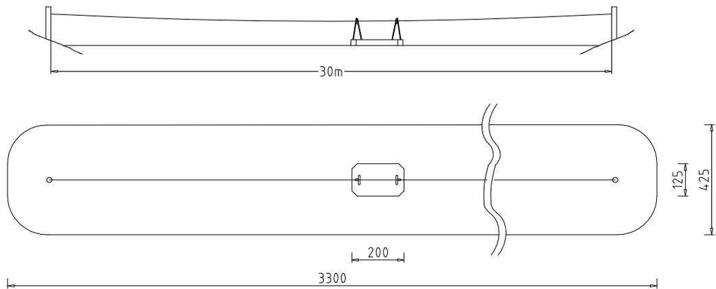
Beschreibung: Schwimmkörper aus Edelstahl, verschweißt, Boden aus Siebdruckplatten mit profilierter, rutschhemmender Oberfläche, Eisenteile Edelstahl, Stahlseil  $\varnothing$  22 mm, 2 Poller zur Befestigung des Seiles am Ufer,  $\varnothing$  ca. 25 - 30 cm, Seilhalterungen.
