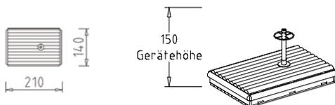
Beschreibung: Schwimmkörper aus Kanthölzern 4/11 cm, gefüllt mit Hartschaum-Kunststoffplatten, Verkleidung und Boden aus Halbhölzern  $\varnothing$  12 cm, 1 Mast zum Anhalten, mit Masthalterung aus Stahl, feuerverzinkt, 2 Stak-Stangen, lose.
