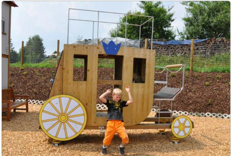
Beschreibung: Auf Unterzügen aus Kanthölzern 9/17 cm ist die Kutsche aufgebaut. Aufbauten in Holz-Riegel-Bauweise mit Kanthölzern 9/9 cm, mit Dreischichtplatten beplankt, Dach, rückwärtige Kletterwand, Sitzbänke innen und am Kutschbock aus Siebdruckplatten, Geländer und Kutschbock aus Edelstahl, Sitzbänke im Inneren aus Kanthölzern, 4 Räder aus HPL 8 mm, mit aufkaschierten Radmotiven. Die Lagerung auf 4 Federn erlaubt kleine Wippbewegungen.
