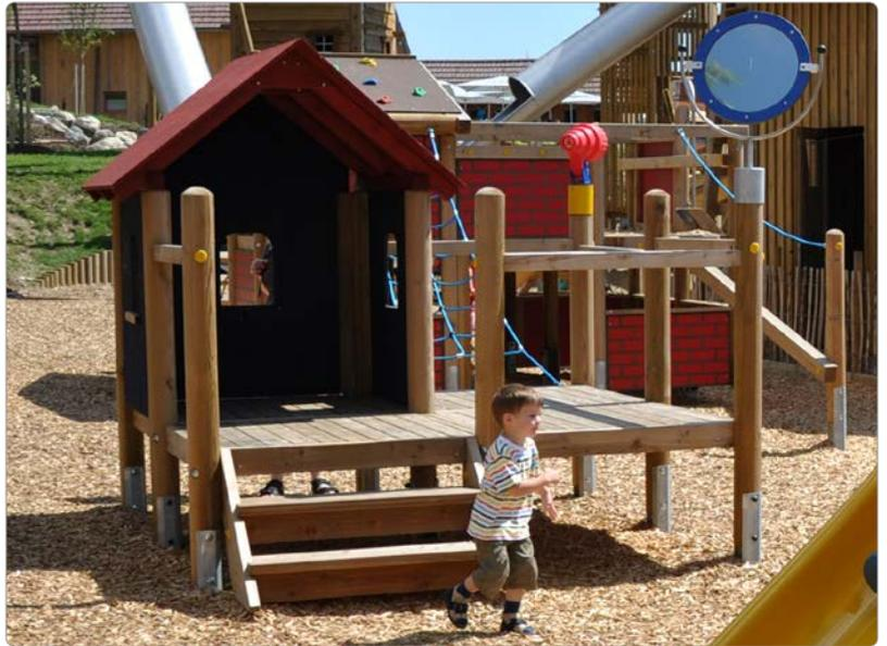
**Beschreibung:** 9 Steher (Pfosten) Ø 12 cm, 4 MAXIMO-Viereckpodeste aus Kanthölzer 4/11 cm und 3,5/10 cm, genietet, mit Stahl-Unterkonstruktion verschraubt, 1 Treppe, Seitenwangen und Trittstufen aus Kantholz 4/23 cm, 1 Spiegel beweglich, aus Edelstahl, 1 Fernrohr (Kaleidoskop) beweglich, 1 Giebeldach, 3 Brüstungswände aus 3-Schichtplatte 20 mm, blau getaucht, 2 Sitzbänke aus Siebdruckplatte 20 mm.
