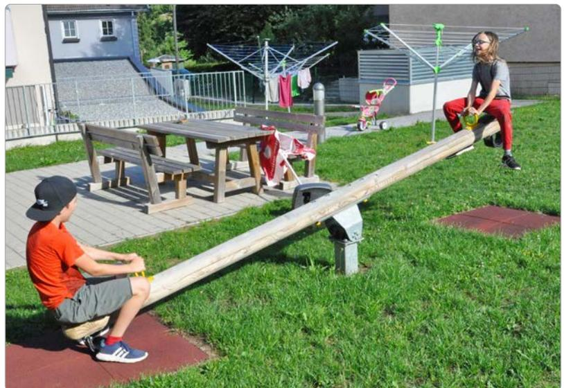
**Beschreibung:** 1 Wippbalken aus Brettschichtholz Ø 14 cm, 2 Wippengriffe aus Flach- und Rundstahl, verzinkt und gelb pulverbeschichtet, 2 Wippensitze aus Siebdruckplatte, Wippendämpfung durch Gummifeder-elemente im Wippenlager und 2 Gummischlaufen mit Gewebeeinlage, 1 Wippensteher aus Formrohr 120/120 mm, feuerverzinkt, zum Einbetonieren.
