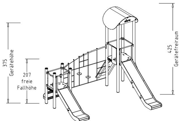
Beschreibung: 8 Standpfosten, 1 quadratisches Podest, 1 rechteckiges Podest, 2 Kreisbogen-Podeste, 1 Aussteifungselement mit Spielfunktion, 2 Brüstungen, 1 Leiter mit Trittstufen aus HPL-Platte mit rutschhemmender Oberfläche, 1 Bergsteiger-Kletterwand schräg, 1 Herkules-Anbaunetz senkrecht mit gebogenem Querträger aus Edelstahl-Rohr, Netz mit unregelmäßiger Teilung sowie 2 integrierten Discs, 1 Tonnendach, 2 Rutschen.
